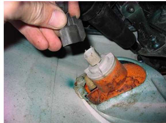
8. Lossa kontaktstyckerna till blinkers (behövs ej på bilar efter 2001-10)
