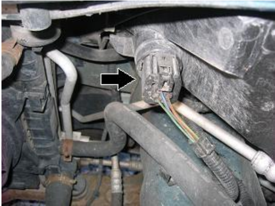
5. lossa sedan kontaktstycket till strålkastaren och lyft bort den
