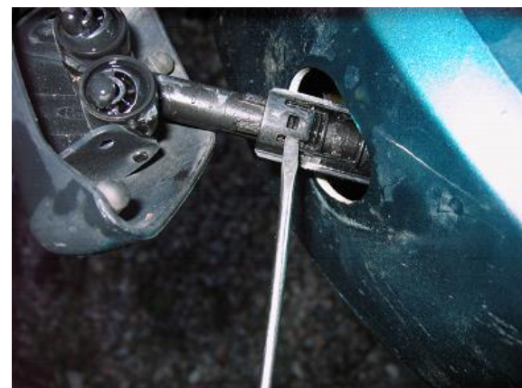
10. Dra ut strålkastarspolarna och bänd försiktigt bort den
