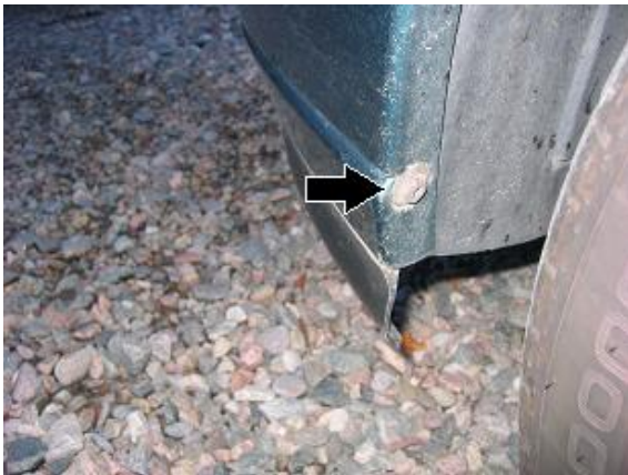
7. Lossa skruven på båda sidor till innerskärmen
