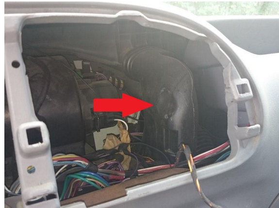
12. och lossa den övre anslutningen till röret som går till golvet.
