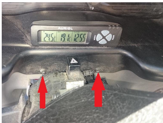
8. Lossa de 2 undre skruvarna till sargen runt hastighetsmätaren.
