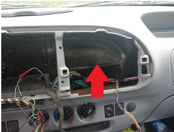
11. Ta bort röret till utblåsen i mitten...
