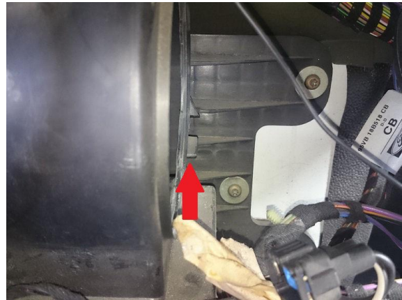
18. Bild på låsningen som spärren snäpps fast i (motor borttagen).
