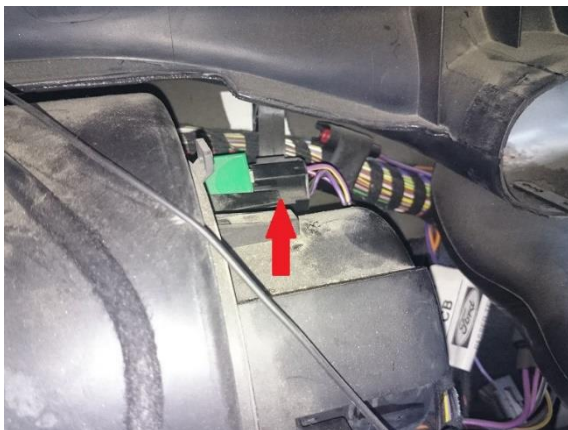
15. och om du har luftkonditionering finns det ett extra relä som du behöver lossa anslutningen på.
