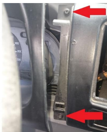
9. Lossa sargen så att du kommer åt de gömda skruvarna till sargen runt utblåsen. Sargen kring hastighetsmätaren sitter med klipps och behöver bändas loss.
