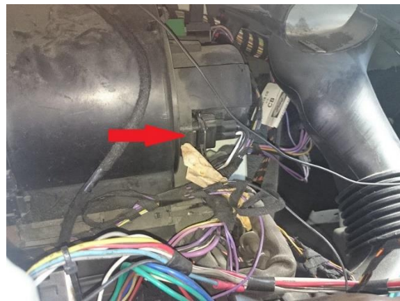
14. Där inne har vi kupéfläkten, lossa anslutningen på fläktmotorn...
