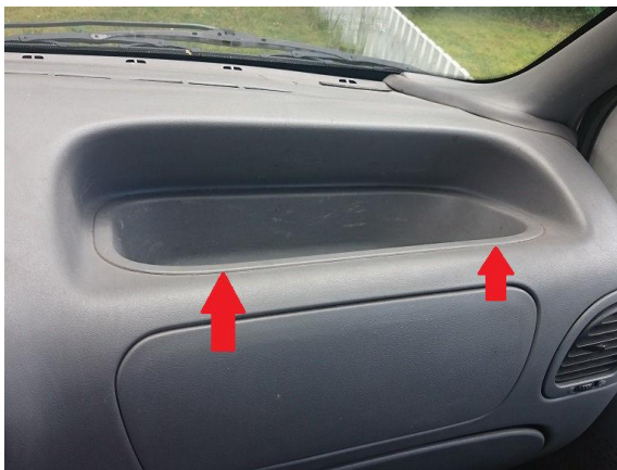
13. För att skapa lite mer utrymme kan du ta bort förvaringsfacket på instrumentbrädan, tryck bara in kanten på facket så ska den släppa från instrumentbrädan.
