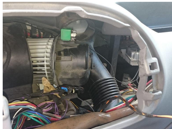
16. Tryck på spärren på baksidan av motorn och vrid hela paket moturs.
