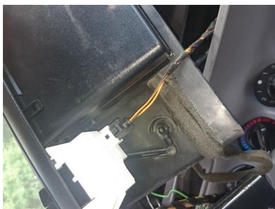
10. Gör sedan samma sak med sargen runt utblåsen, den sitter också med klipps. Lossa anslutningen till klockan.
