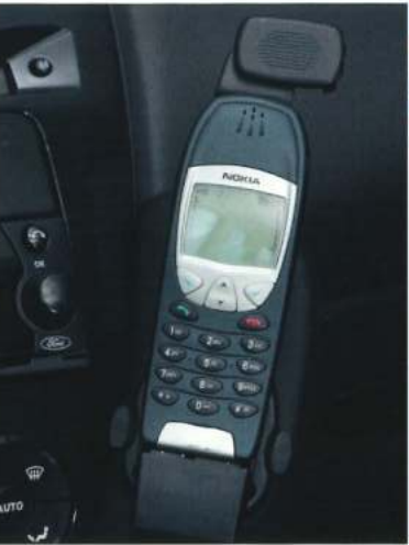
Installationssats för mobiltelefon innehåller telefonkonsol, hållare och en bassats med antenn och radiomuting.
