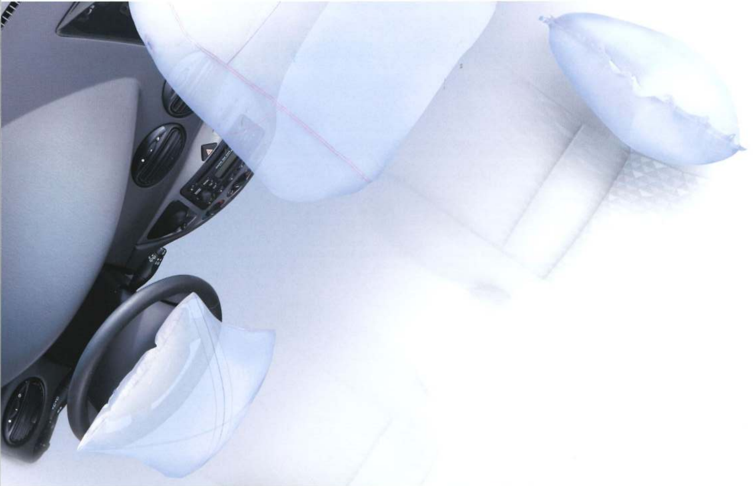
Förarens och framsätesspassagerarens krockkuddar* samverkar med karosstrukturen och skyddar maximalt inom 50 millisekunder vid kollision. Sidokrockkuddar skyddar huvud och överkropp mot krockkrafter från sidan.
