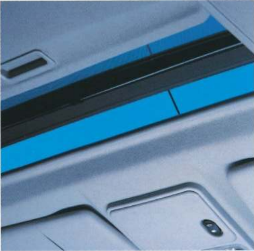
Elmanövrerad sollucka i glas som stängs automatiskt när tändningen slås av.
