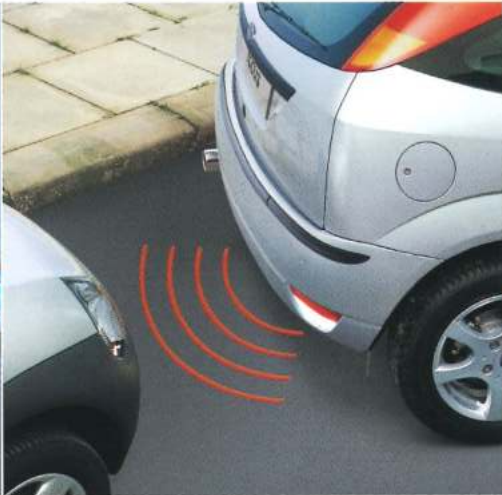
Parkeringsensor placerad i bakre stötfångaren använder ljudsignal för att hjälpa föraren att bedöma avståndet vid parkering.
